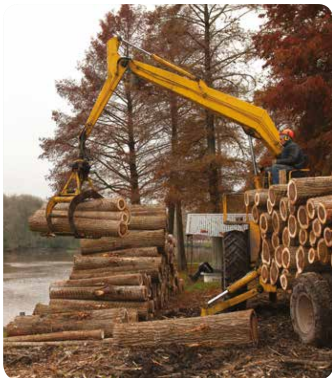
Equipo de carga y transporte de madera. Tractor con pluma hidráulica incorporada y acoplado en la playa de descarga junto al río Carabelas, provincia de Buenos Aires. Autor Pablo Oliveri, gentileza UCAR-MAGyP.
